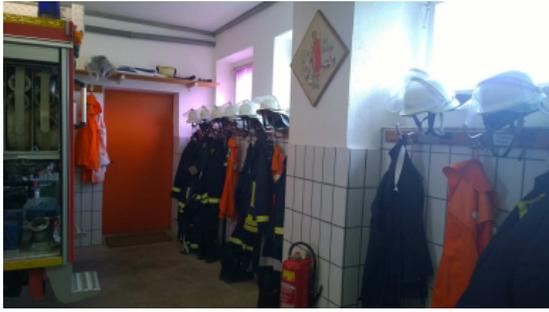
Die Unterbringung der Einsatzkleidung / Spinde in der Fahrzeughalle entspricht nicht den Anforderungen der Informationsschrift - Sicherheit im Feuerwehrhaus (GUV-I 8554). Diese Lösung wird momentan nur geduldet, da es sich bei dem TSF um ein benzinbetriebenes Fahrzeug handelt.
